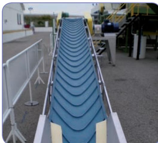
Les revêtements peuvent être fabriqués sans profil, **lisses** ou avec des profils. Elles peuvent être **à chevrons**, avec des profils de différentes formes et dimensions, **Grip Top** à profil rugueux, **spéciales** avec un profil réalisé sur demande et adapté aux matériaux à transporter et à l'inclinaison de travail.
