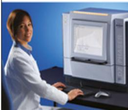
D2 PHASER: Difracción de Rayos X de sobremesa con cambio de muestras automático.
